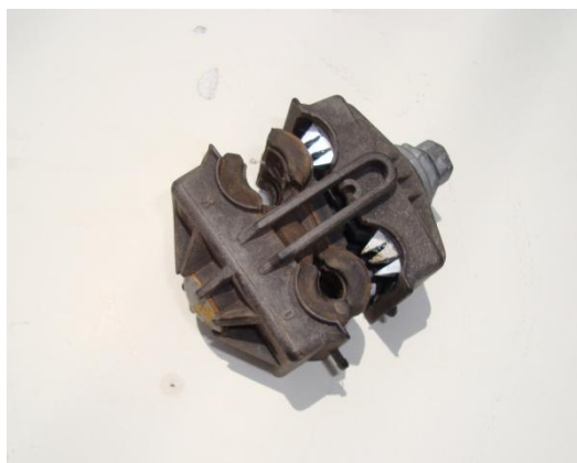
Figura 1: O by-pass, colocado nos fios de força antes do medidor de energia, tem dentes que “mordem” o fio e fazem um contato direto com a rede da casa. Parte da energia é medida, mas outra parte busca percorrer um caminho mais curto, e assim, a maior parte não é medida, caracterizando o furto, ou a subtração de “coisa móvel”. (Fonte: Lobão et alli., 2012)
